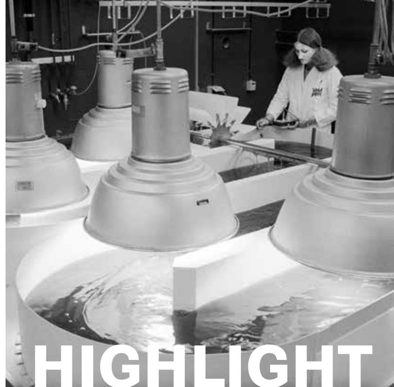
In einer Algenversuchsanlage erforschen Jülicher Wissenschaftler, wie sich mit Hilfe von Mikroalgen und Bakterien Abwässer reinigen lassen und die entstehende proteinreiche Biomasse aus Algen und Bakterien zu Tierfutter verarbeitet werden kann.
